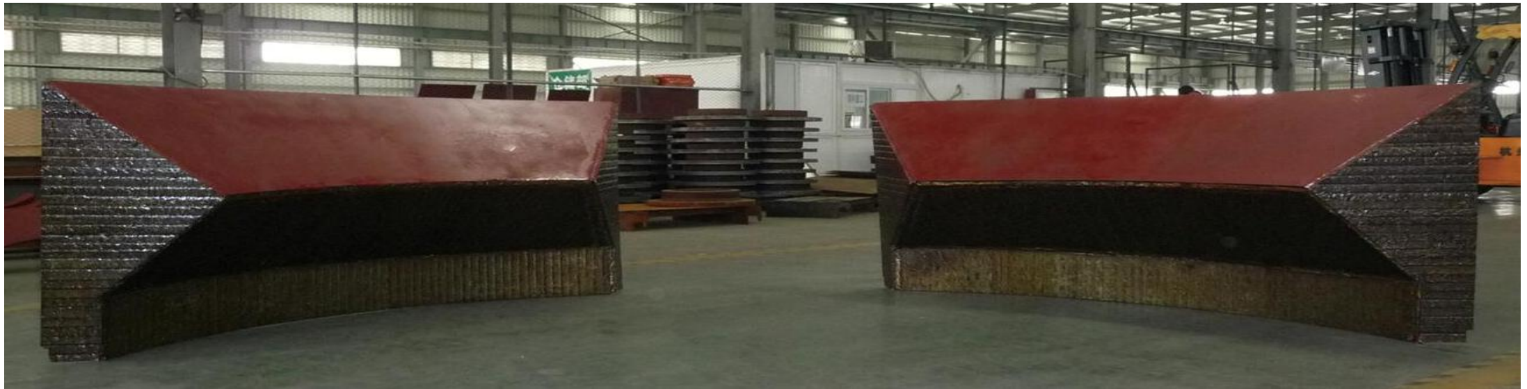
磨煤机分离器导向装置--Duroxite™10+10复合材料
